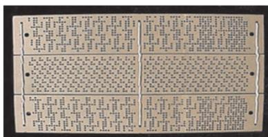
Fig 3.- Tarjetas perforadas
