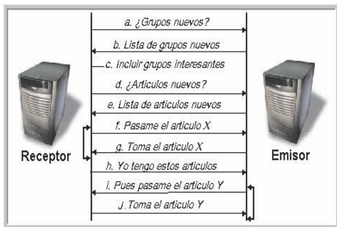
Fig 5.- Esquema del sistema de distribución de grupos y artículos entre dos servidores NNTP.
