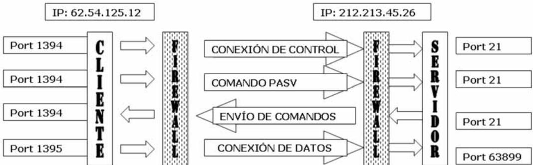
Ahora acabamos de descubrir el motivo de la existencia del PASV MODE Podemos ver como es el Cliente quien establece la Conexión de Datos, respetando la seguridad del Firewall que impide las conexiones entrantes Ahora no hay ni una sola conexión entrante al Cliente
