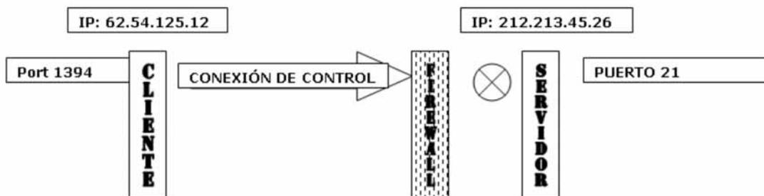
Pero este caso no es muy realista, porque normalmente el Firewall que defiende La RED donde se encuentra el Servidor FTP se configura para admitir conexiones entrantes y salientes para los programas Servidores. Si no, sería imposible ni tan siquiera establecer la Conexión de Control.
